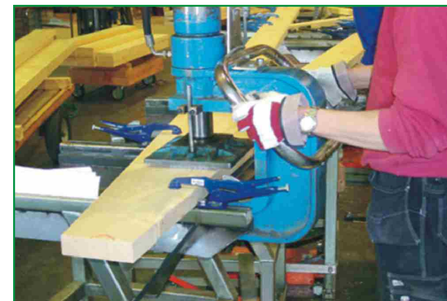
Mediniai elementai sujungiami hidrauliniu presu, naudojant „MiTek“ dantytas plokšteles
