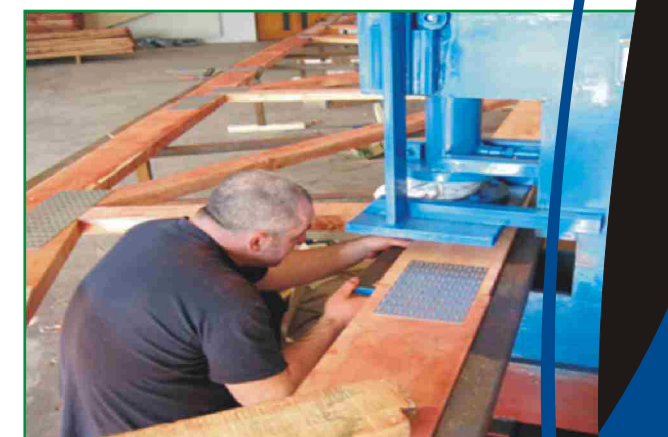
Mediniai elementai sujungiami hidrauliniu presu, naudojant „MiTek“ dantytas plokšteles
